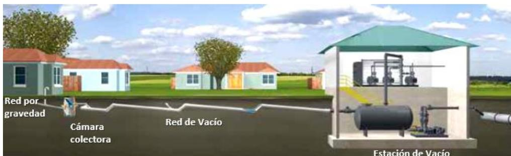
Imagen 2. Diseño clásico de un sistema de alcantarillado por vacío potable, alcantarilla y saneamiento, CONAGUA 2015.
